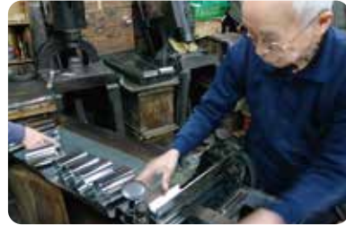
2 ブリキ板をまるめる 切断した板を専用の機械を使って一つ一つまるめます。機械に板を素早く、歪みなく差し込んでいくのは簡単そうに見えてまさに職人技です。
