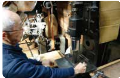
4 底を付ける 底も缶の胴体同様、織り込んで上から圧力を加える形で接合。缶の高さに合わせて機械を都度調整。微妙な調整も長年の経験によりなせる業！
