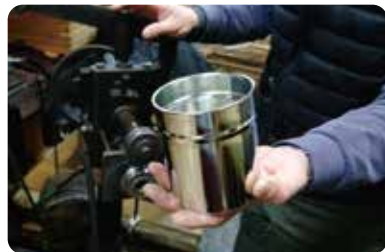
5 紐出しをし、完成 蓋をはめ込んだ時に蓋がしっかり止まるよう、缶の胴体に突起を造ります。この突起を造ることを“紐出し”と言います。
