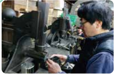
3 まるめたブリキを接合する ブリキの端を織り込んで両端を組み合わせ、上から潰して接合。はんだを使用していないため、錆の心配がありません。
