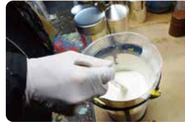
2 塗料の調色及び硬さの調整 お客様のご要望に合わせて調色します。塗料を、濃すぎず薄すぎず丁度いい硬さに調整するには十分な経験が必要です。
