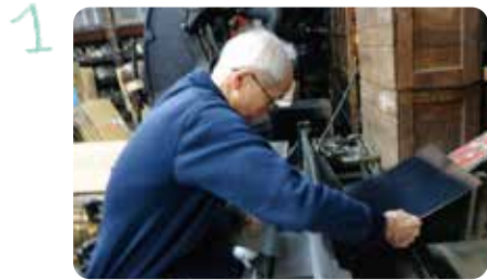
1 ブリキ板切断作業 切断用の器具を使って大きなブリキ板を1枚、缶のサイズに切断。
