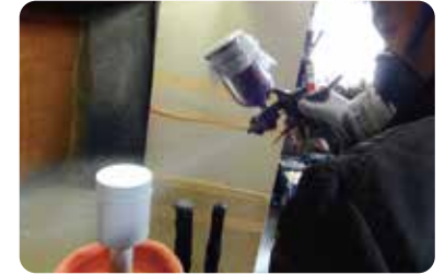
3 塗装 一つ一つ缶をろくろに載せ、色むらにならないよう、均等に塗料を吹き付けます。吹き付け塗料だからこそ独特の美しい色艶のある缶に仕上がるのです。 塗装ブースは50年程前、先輩職人の方がハンドメイドで造ったオリジナルのもので、それを受け継いで大事に使っています。
