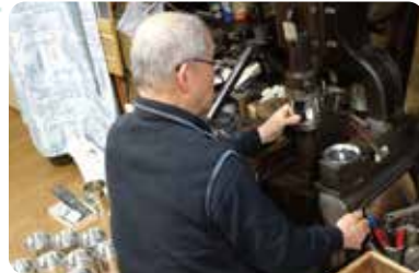
4 天底を付け 完成 機械で、缶の天板の部分と底板を押し込んで最終的に缶の完成。色々な高さ、大きさの缶があるので、経験と感覚を頼りに缶のサイズによって天底を押し込む高さの調整をしています。
