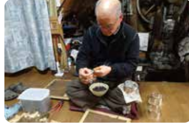
2 ブリキ板をまるめる 切断したブリキ板を缶の部品毎に異なる直径の円形に丸めます。一つ一つ狂わず同じサイズの円形にするのはまさに職人技です。
