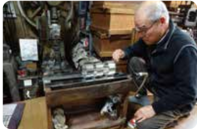
3 まるめたブリキを接着する まるめたブリキ板の接合部分を接着。焦げたりしないよう、均等に接着するには熟練のスキルが必要です。
