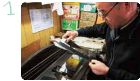
1 ブリキ板切断作業 ブリキの板から缶の部品となる部分を0.1mm単位で正確に裁断。
