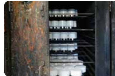
4 窯で焼く 窯で1時間半塗料を焼き付けます。缶の色やサイズ、外の気温によって缶を焼く位置や時間を考慮しなければなりません。
