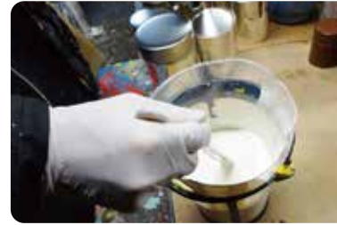
1 2 塗料の調色及び硬さの調整 お客様のご要望に合わせて調色します。塗料を、濃すぎず薄すぎず丁度いい硬さに調整するには十分な経験が必要です。
